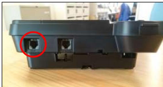
端の「回線」と書いているところに、電話機コードを差込み、反対側の端子を特設公衆電話ボックス内に設置しているモジュラーケーブルに差し込む。
